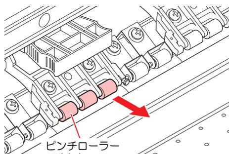
**5** 新しいピンチローラーをセットして、Oリングで固定する。
