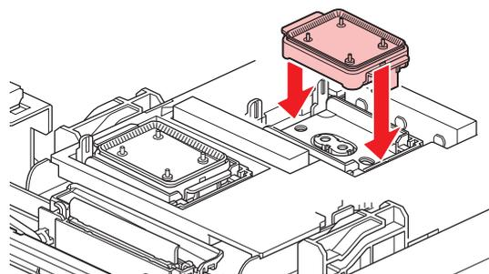
**8** 交換が終わったらカバーを閉じて、[ENTER]キーを押す。**ステーション周辺の吸収材の交換**
