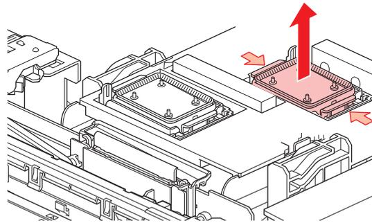
**5** 【Sbインク、TPインクの場合】メンテナンス液を溜めた容器でキャップのメッシュの面を下にしてゆすいでください。取り出したら樹脂部分はしっかりと拭き取ってください。
